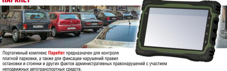
Как и мобильный комплекс **ПаркРайт** портативный комплекс **ПаркНет** использует программный алгоритм распознавания стационарного комплекса **АвтоУраган**. Портативный комплекс производит автоматическую фотофиксацию, распознавание номера автомобиля и формирование пакета данных с указанием даты, времени и места события и передачей его по беспроводным линиям связи в центр обработки данных.
