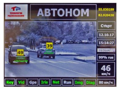
Каждый **АвтоНом** снабжен приемником геопозиционирования ГЛОНАСС/GPS. Его наличие позволяет точно знать место установки каждого конкретного прибора, а также определить время и направление движения зафиксированного транспортного средства.
