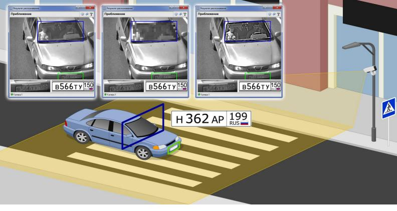
Комплекс **RNCam** автоматически определяет зону лобового стекла автомобиля.
