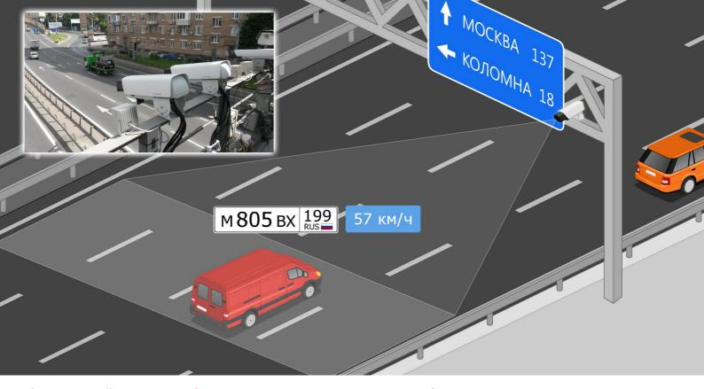
Стационарный комплекс **RNCam** измеряет скорость автотранспорта безрадарным методом (по видеокадрам) в режиме 7/24 при любой погоде. Все идентифицированные номерные знаки автоматически проходят проверку по базе розыска автотранспорта.
