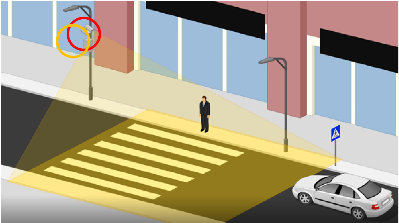
Рисунок 1.5 – Пример расположения оборудования комплектации «Нерегулируемый пешеходный переход». Красный кружок – распознающий видеодатчик, желтый кружок – обзорный видеодатчик
