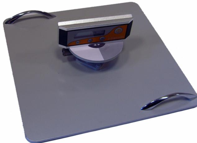
Рис. 3.11 – Измерение уклона дороги
