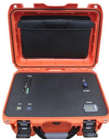
Рисунок 20 - Система питания и приема/передачи данных
