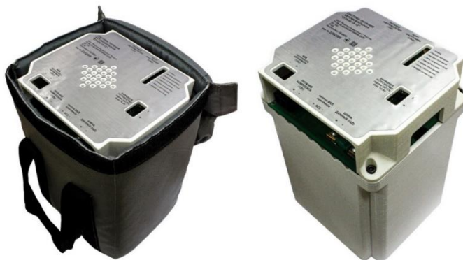
Рисунок 19 - Внешний вид системы питания в термосумке и без нее
