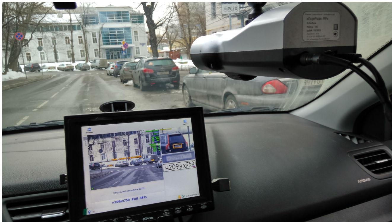
рис. Внешний вид АПК «ПаркРайт-МР», вариант исполнения «01», видеоблок модели VBE
